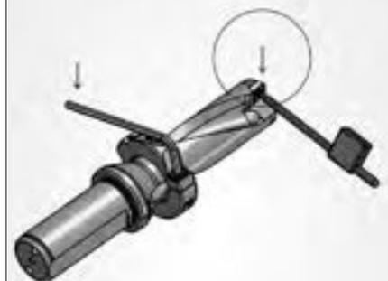
面取り リングを締付け、ドリルチップを締付ける。
