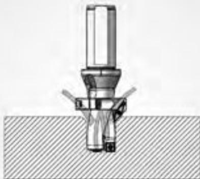
チップの寿命を長くするために、外部冷却や内部冷却付ドリルをご使用下さい。
