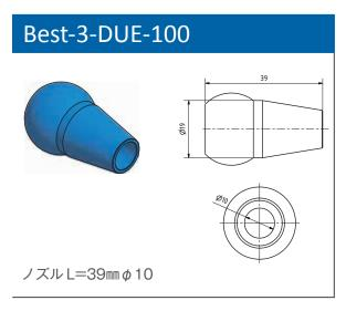
ノズルはアルミ製 オプション:プラスチック製、スチール製
