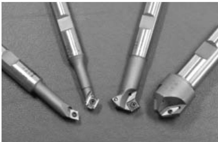
穴面取り加工径  $\phi$  2.0mmより    コーナー面取りは1mmより
